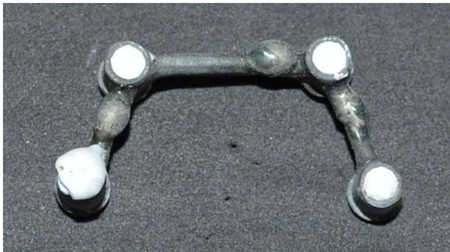
Figura 30. Probetas soldadas y tratadas con chorreado de corindón de 100micras a 2N de presión.
