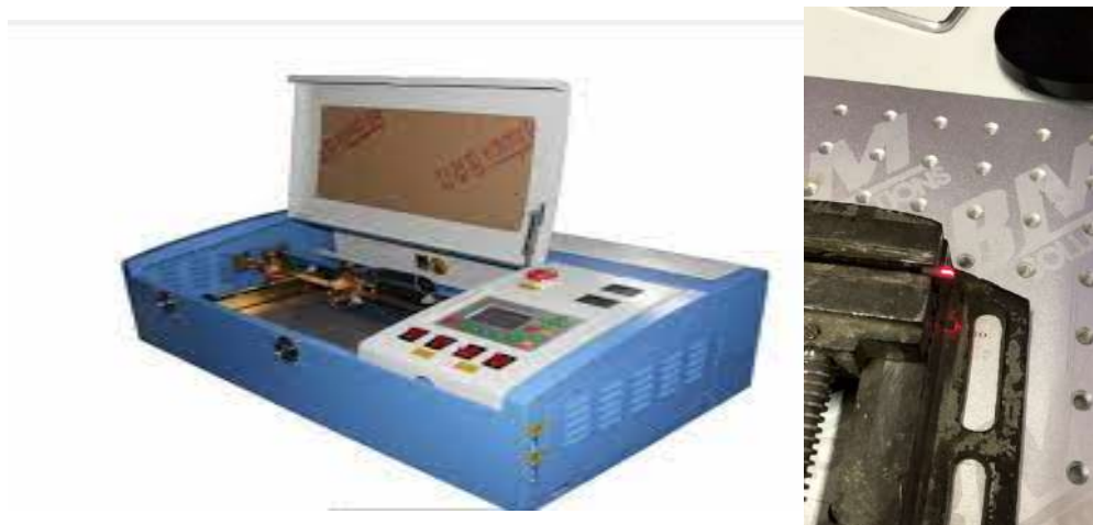
Figura 8. (A) Máquina de Grabado y Corte Laser BBM Modelo 420Pro. (B) Soporte y Grabado de líneas con láser.
