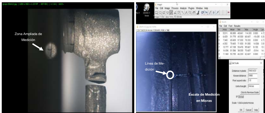
Figura 22. Medición lupa estereoscópica Lupa Zeiss Stemi 2000-C, con cámara Nikon incorporada
