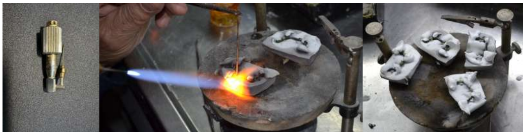
Figura 27. Soldadura de segmentos en probetas con Soplete y llama dardo a base de gas propano y oxígeno.
