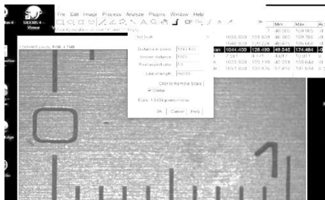
Figura 21. Calibración de Software ImageJ con la escala de magnificación
