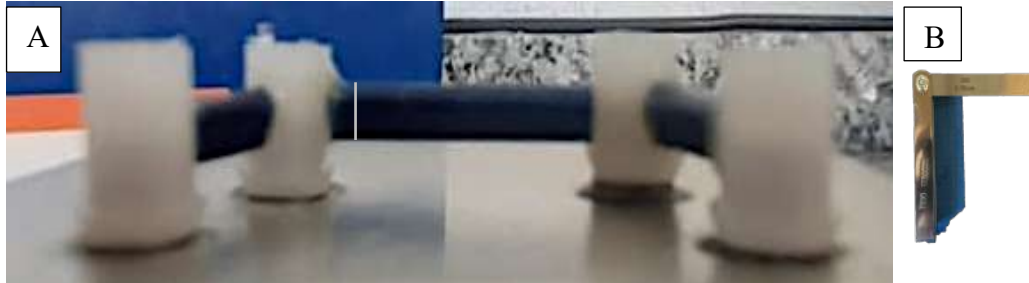
Figura 12. (A) Modelo de Probetas Enceradas para colada seccionadas con calibre a 0.15mm. (B) Sondas calibradas,
