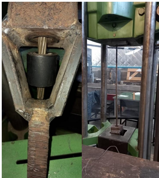
Fig. 35: Sujeción rígida de los extremos del cable y probeta siendo ensayada a tracción
