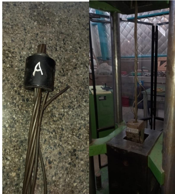
Fig. 36: Falla del anclaje del cable con la cuña y falla por tracción del cable, respectivamente
