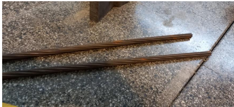
Fig. 32: Acero tesado C1900, de 7 alambres, con Baja Relajación
