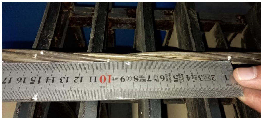
Fig. 37: Deformación del cable luego del ensayo de tracción
