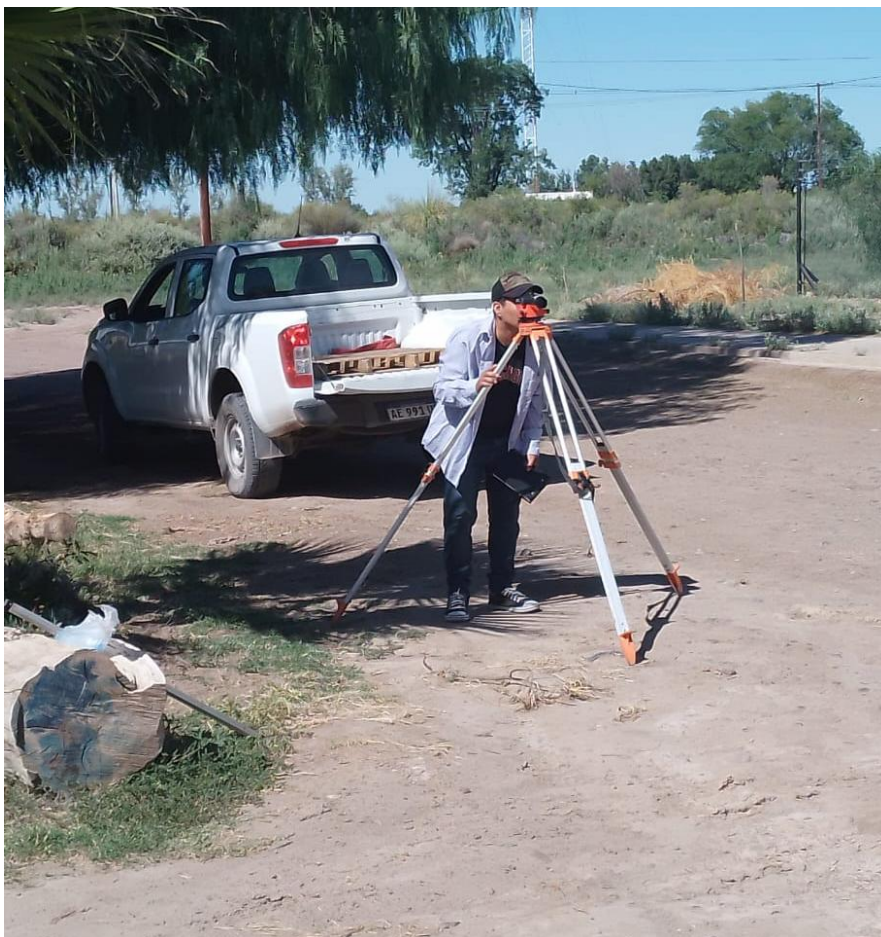
Figura 24. Toma de nivel sobre un punto del sifón
