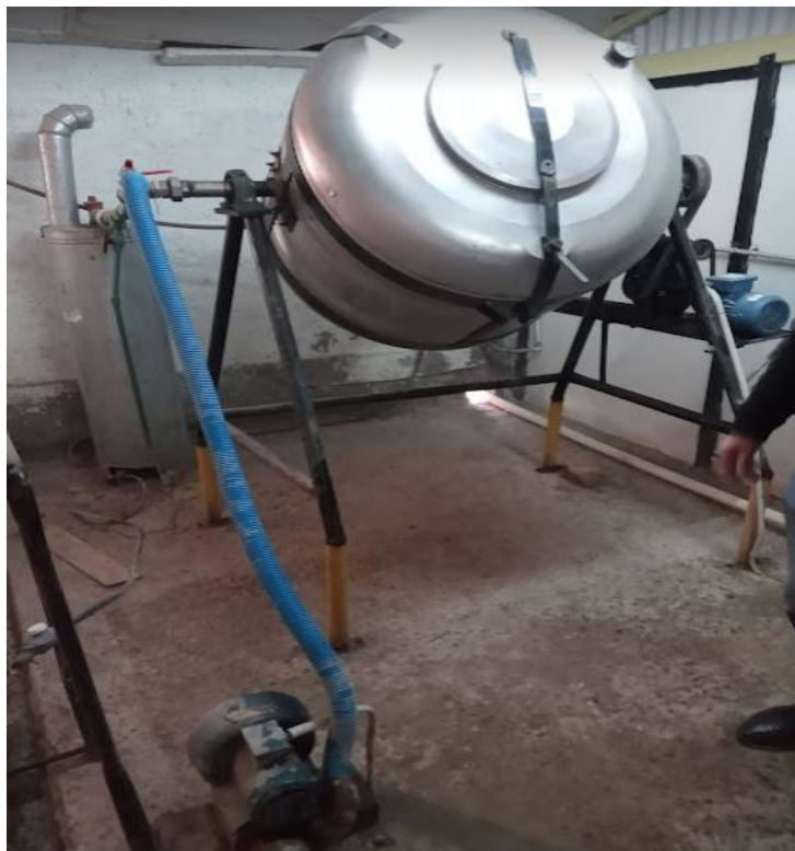
Figura N° 27: Imagen del Pasteurizador rotativo junto con la caldera. Fuente de elaboración propia, 2022.
