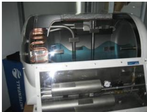
Figura 2.27. Tanque de almacenamiento de hidrógeno líquido.
