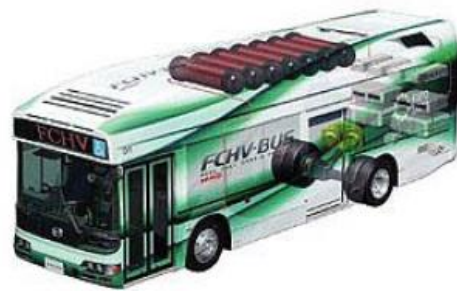
Figura 2.25. Tanques de Hidrógeno a presión - Disposición de tanques a presión en autobús.
