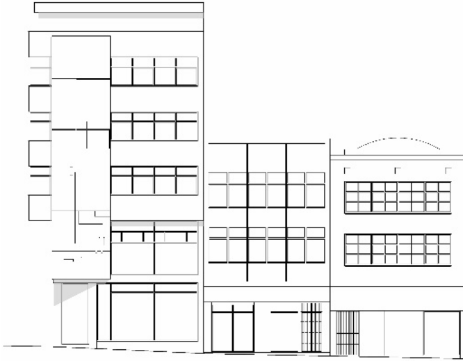
Figura 10. Fachada Sur y fachada Este con muro cortina o mural escultórico.
